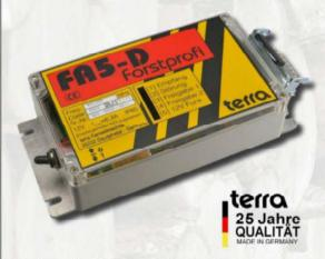
Technische Systemdaten; gelten für alle Versionen: Übertragungs-Sicherheit: Hammingdistanz HD=4, mit Doppelauswertung und 2 Sicherheitskreisen! Max. Strombelastbarkeit der Relaisausgänge: 10A (7,5A). 2 getrennt abgesicherte Stromkreise.
