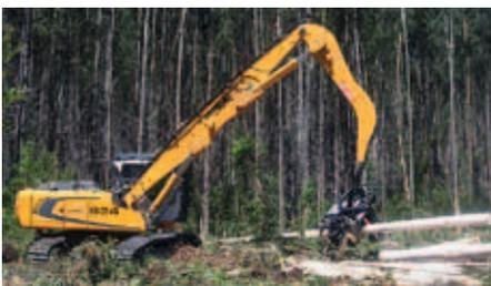
Der TH75 kann mit einer Eukalyptus-Entrindungs-ausrüstung ausgestattet werden. Der synchronisierte Vorschubskreis und die parallelgesteuerten Entastungsmesser und Vorschubräder halten den Stamm in optimaler Stellung und gewährleisten wirksame Entrindung.
