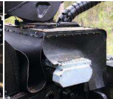
Abdeckungen schützen den Kranfuß.
