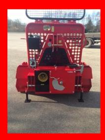
EH Model hat gelenkwellengetriebene Hydraulik zu Bedienung von Kupplung und Bremse via Funkoder Kabelsteuerung.
