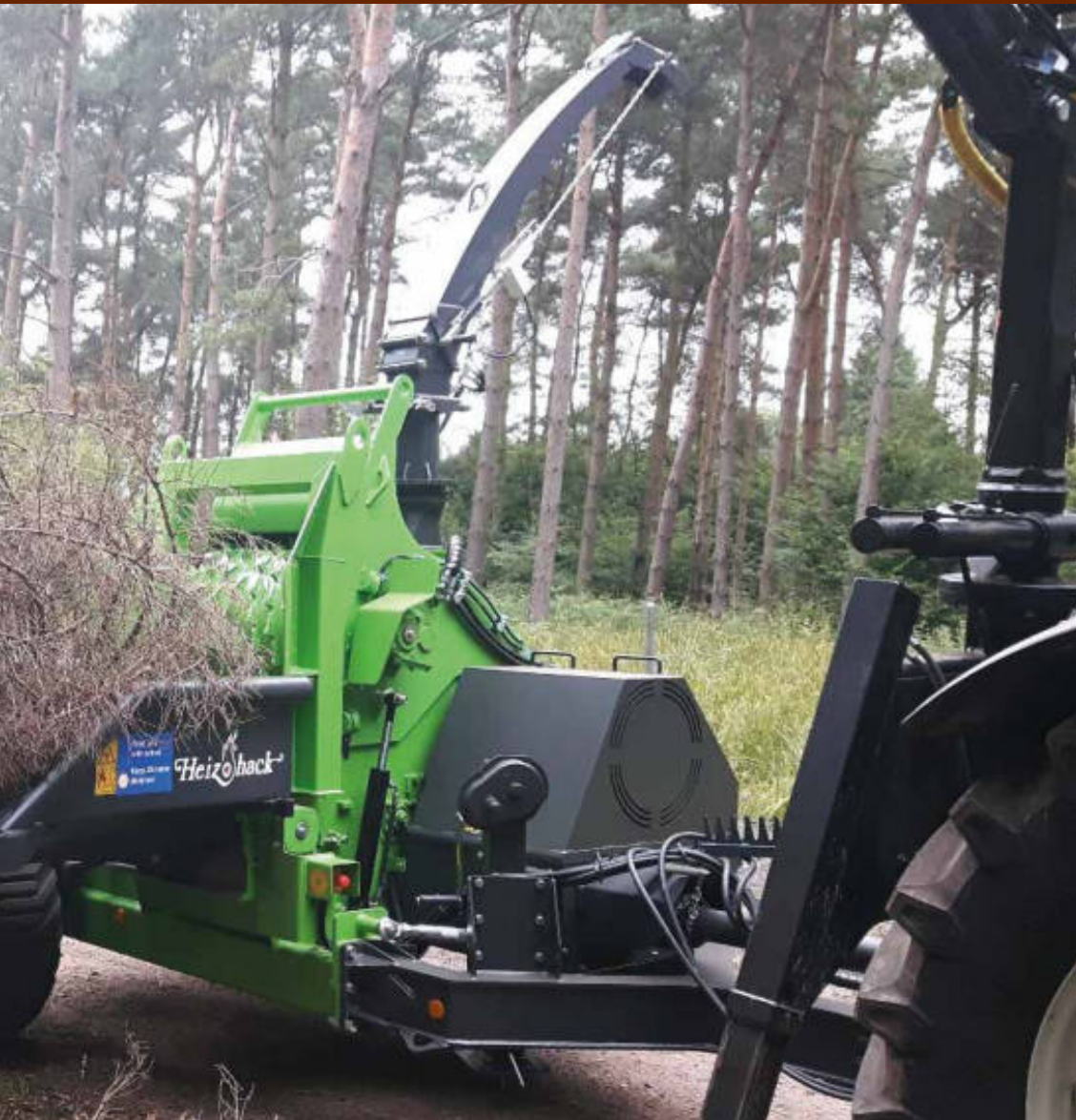
Einzugsklappe mit Kettenband
