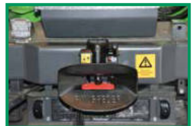
Automatische Anhängerkupplung mit Druckluftanschluss
