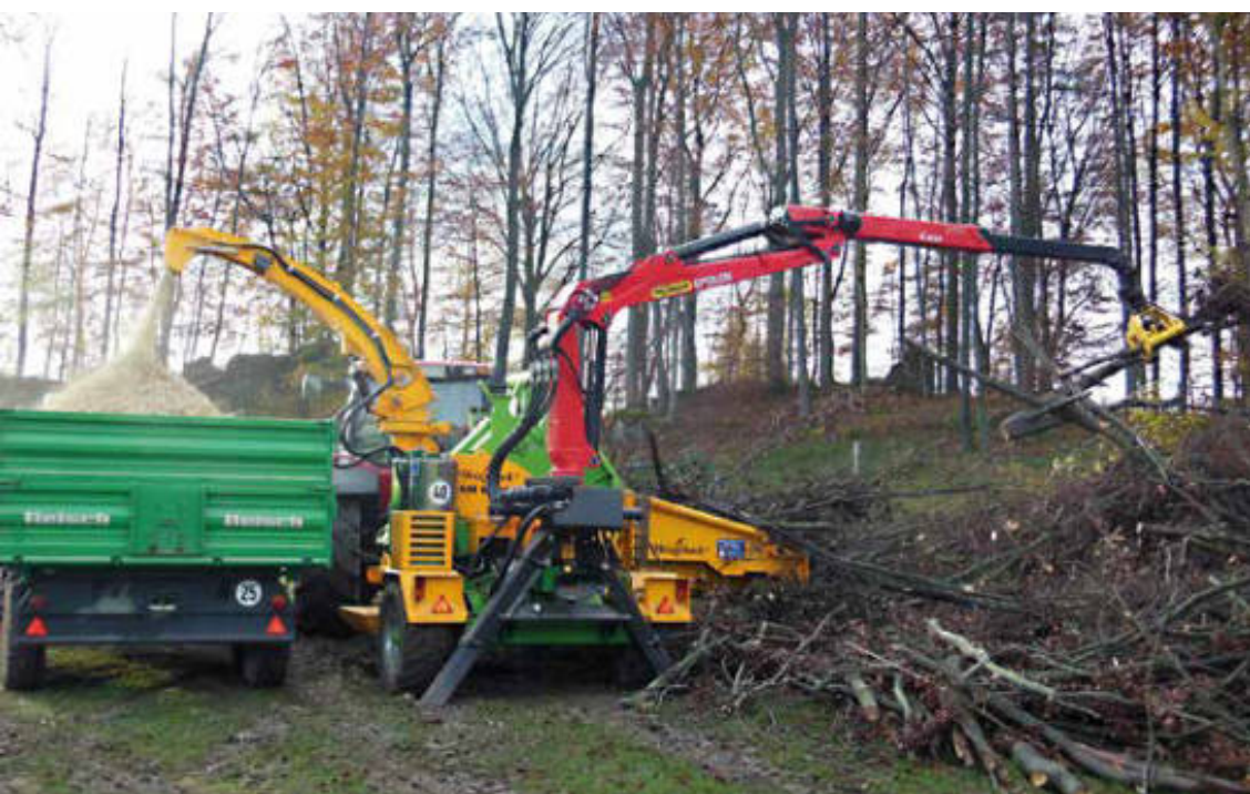
Vorgelagerte Einzugswalze mit starken Hydraulikantrieb
