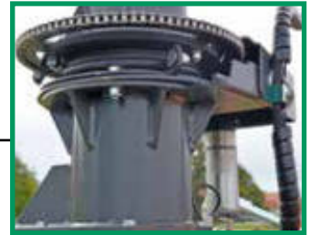
Elektrische Turmdrehung Antrieb über E-Motor
