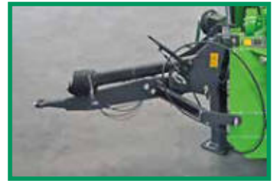
Hitch-Anhängung Höhe: 500 mm
