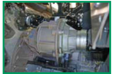
Direkter Antrieb des Hackers vom Motor. Volle Leistung inkl. Werksgarantie.
