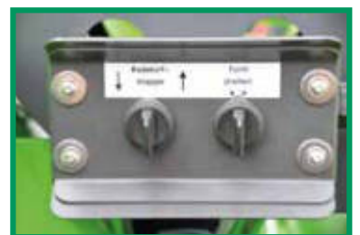
Elektrische Turm- und Klappenverstellung
