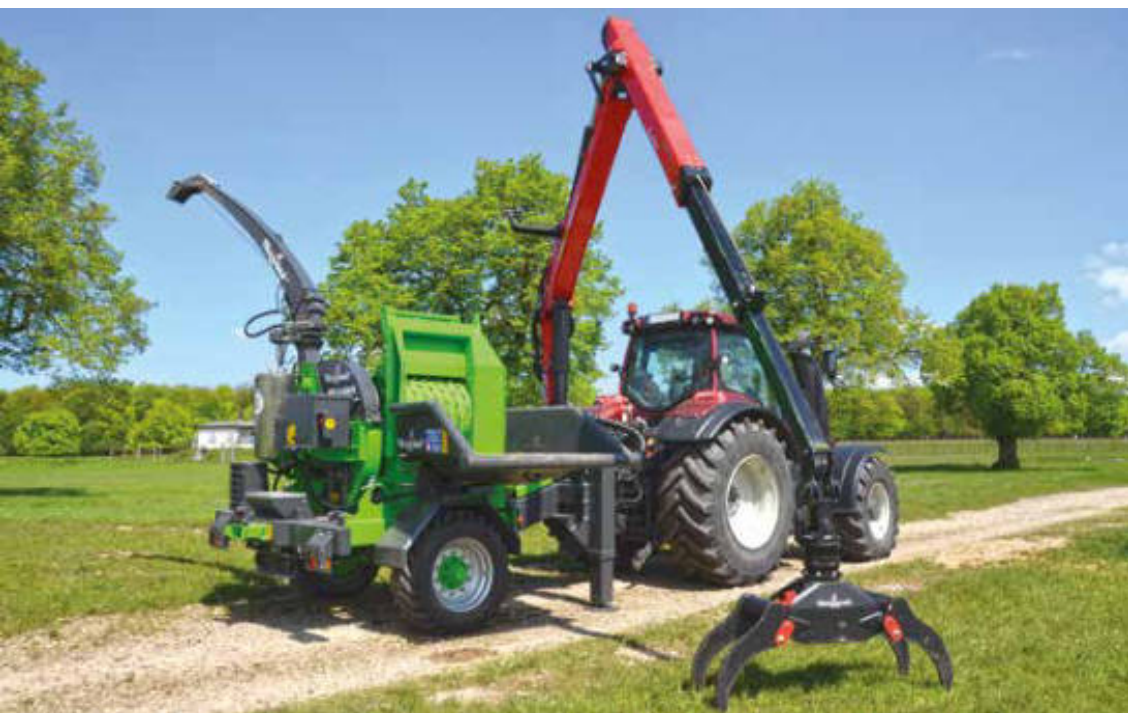
Zugdeichsel höhenverstellbar 500, 600, 900 und 1000 mm
