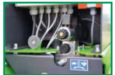
Einzugsgeschwindigkeit regelbar durch Mengenteiler
