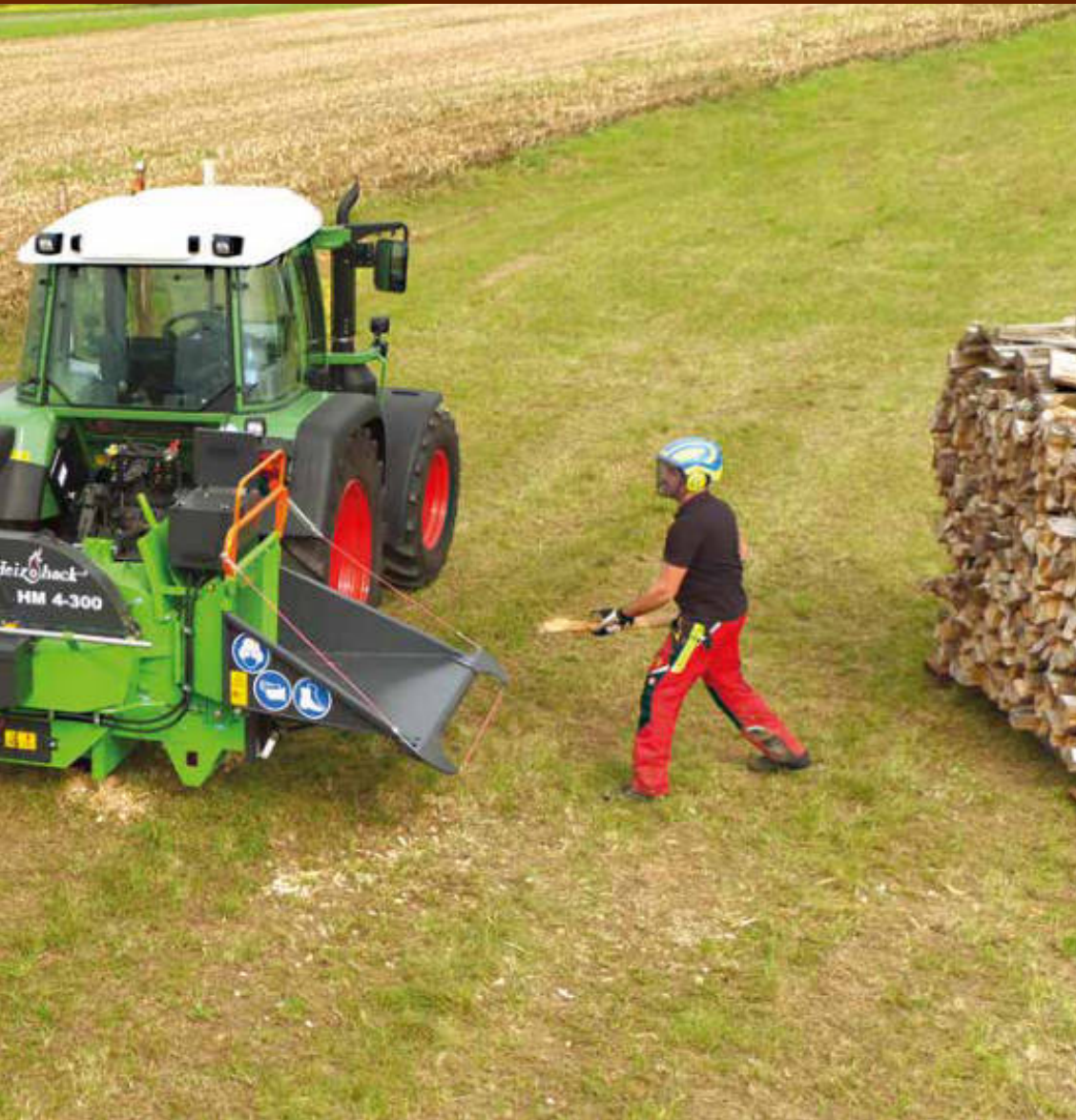
Einzugsgeschwindigkeit regelbar durch Mengenteiler
