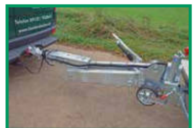
Höhenverstellbare Zugdeichsel mit Zugöse oder Kugelkopf- kupplung
