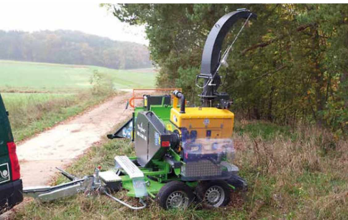
Höhenverstellbare Zugdeichsel mit Zugöse oder Kugelkopf- kupplung
