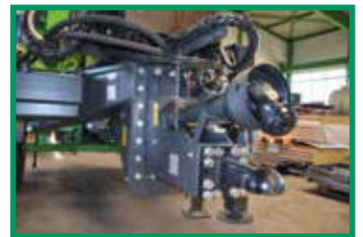
Zugdeichsel höhenverstellbar 500, 600, 900 und 1000 mm
