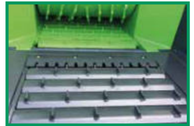
Einzugsklappe mit Kettenband
