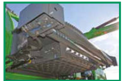
Vorgelagerte Einzugswalze mit starken Hydraulikantrieb
