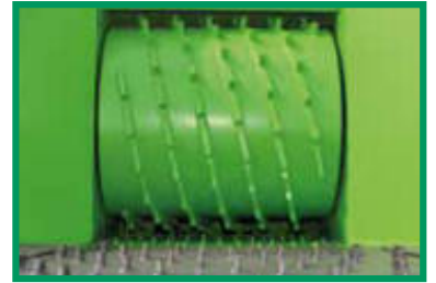
Anpressrolle mit Stahlzähne Ø 600 mm
