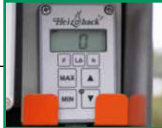
Drehzahlregelter Einzug Anti-Stress-Control
