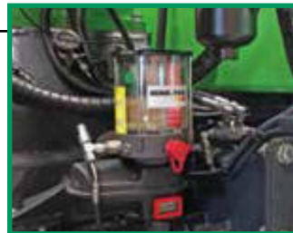
Automatische Zentralschmierung Einfache und schnelle Schmierung
